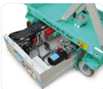
Montaggio della componentistica molto ordinato ed ergonomico per lo svolgimento della manutenzione.
