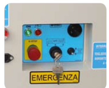
Pannello comandi a terra intuitivo e ben protetto dagli urti involontari.
