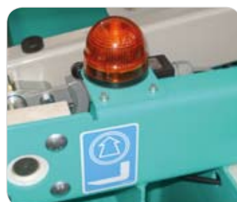
Girofaro lampeggiante avvisatore di presenza della macchina in azione.
